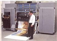
Durst Hochleistungs-Ink-Jet-Drucker Rho 160 druckt auf einer Breite bis 158 cm und ca. 45 m2 pro Stunde.
