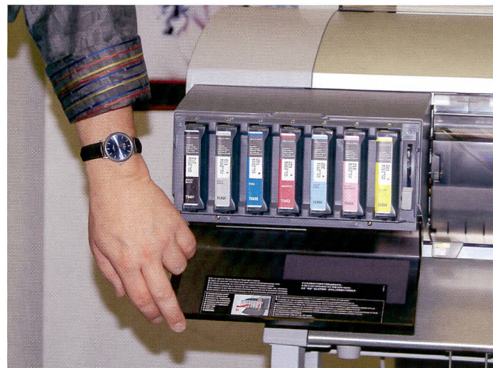
Sieben Tintenbehälter sorgen für feine Farbabstufung. Jede Farbkartusche lässt sich einzeln auswechseln.
