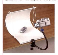
eine flexible Kunststoffplatte, die mit Hilfe einer Perlschnur und mehreren Bohrungen am Rand in die gewünschte Wölbung gebracht wird. Je nach Länge der Perlschnur ergeben sich alle möglichen Biegegrade bis hin zur Hohlkehle.
