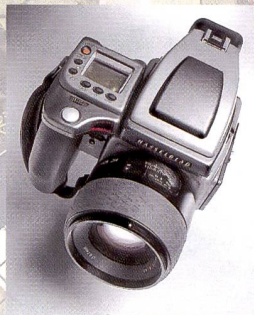
Hasselblad weicht mit der H1 für das 6x4,5 System erstmals vom gewohnten 6x6 Format ab und integrierte schnellen Autofokus und Schnittstellen für digitale Rückteile.
