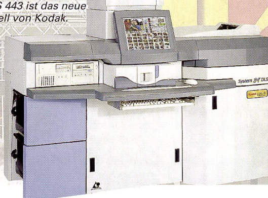
Im Minilab System 89 DLS werden Kleinbild-, APS- und 120er Rollfilme verarbeitet.
