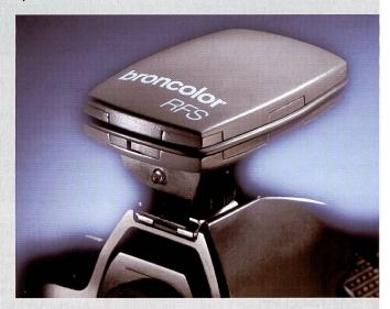
Die Synchronisation des Blitzes erfolgt entweder über den Mittelkontakt des Zubehörschuhs oder über ein Verbindungskabel mit der Kamera. Der Minisender verfügt über 10 digital codierte Kanäle. Dies ist ein bedeutender Vorteil gegenüber den bisherigen IR-Sendern. Auf einen Hauptschalter wurde bewusst verzichtet, weil die Lithium-Knopfzelle eine Lebensdauer von ca. 5 Jahren hat.
