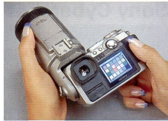
Der Kamerakörper schwenkt um das Objektiv.
