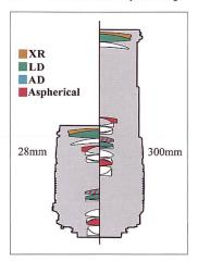
setzt und sorgt für gleichmässige Helligkeitsverteilung, unabhängig davon, ob sich das Zommobjektiv in Weitwinkel oder Telestellung befindet. Das neue 1:3,5-6,3/28-300 XR Ultra Zoom kann bis Blende 22 abgeblendet werden.
