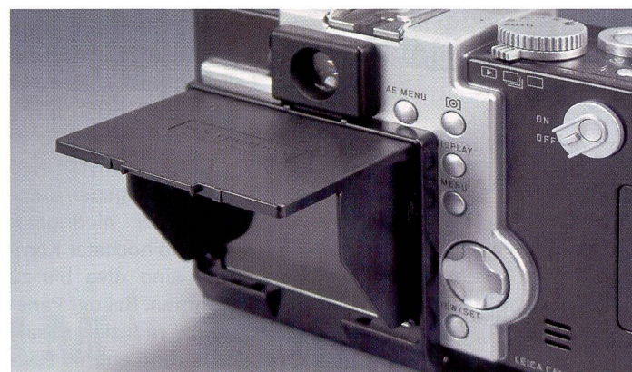
Praktisches Detail: Zu beiden Kameras wird ein Lichtschacht mitgeliefert, der die Display-Betrachtung bei Tageslicht erleichtert.
