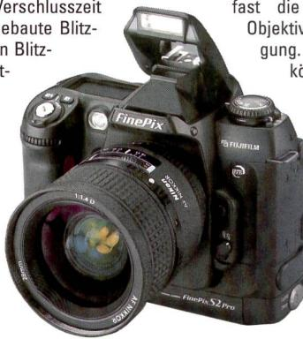
Mit der FinePix S2 Pro steht fast die gesamte Nikon Objektivpalette zur Verfügung. Die Typen D und G können problemlos verwendet werden, andere Nikkore sind mit gewissen Einschränkungen einsetzbar. Für die Belichtungsmes-
