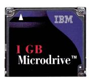
Der IBM Microdrive ist eine Miniatur-Festplatte, mit demnächst bis zu zwei Gigabite Speicherkapazität. Sie ist kompatibel zum CompactFlash Standard.
