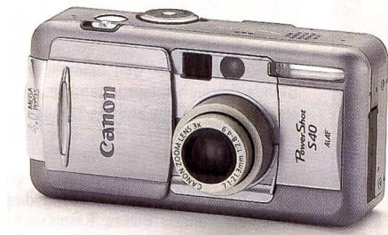
ium-Ionen Akkus NB-2L lassen sich laut Herstellerangaben bis zu 170 Fotos pro Ladung realisieren – bei eingeschaltetem Monitor. Es steht auch ein optischer Sucher zur Verfügung. Der Brennweitenbereich des Zoons liegt bei 35 bis 105mm (vergleichen mit Kleinbild), zusätzlich steht ein digitales Zoom zur Verfügung. Zusammen ergibt sich so ein 11facher Zoombereich. Die Nahgrenze beträgt 80 cm, im Makromo-
