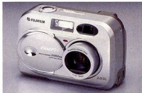
mitgelieferte 16MB-SmartMedia-Karte passen je nach Qualitätsmodus zwischen 20 und 75 Bilder oder bis zu insgesamt 94 Sekunden Video im AVI-Format. Jeder einzelne Videoclip ohne Ton ist dabei maximal 20 Sekunden lang. Auf dem 1,8-Zoll Farb-LCD-Bildschirm lassen sich die Bilder oder Videos direkt nach der Aufnahme überprüfen.
