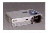
Der Liesegang ddv 911 ist mit einer dvi-Schnittstelle ausgestattet und leistet 1400 ANSI-Lumen und erlaubt eine Keystone-Korrektur von 40°. Auflösung: XGA.
