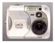
in die C-40Z00M noch diverse Bildoptimierungsroutinen integriert, z. B. eine Pixel-Mapping- und eine Noise-Reduction-Funktion.
