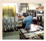
auf das kommende Modell 330 einen Ausbau notwendig. Die Produktion erfolgt in kleinen Lots auf Montagewagen. In Anbetracht der rund 400 bis 450 Frontiers, die pro Monat in alle Welt verschifft werden, ist dies eine sehr flexible und effiziente Produktionsmethode. Und doch sieht man eigentlich relativ wenig vom gesamten Werdegang eines Frontier, weil über 90 Prozent der Komponenten von Zulieferern stammen - eine Ferti-
