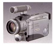
der basiert auf einem 1/3.6"-CCD-Sensor, der mit seinen 1,33 Millionen Pixeln detailgetreue Aufzeichnungen von verzerrungsfreien Videos und Fotos ermöglicht. Sharp hat dem Gerät für den semiprofesionellen Anwender eine Funktion eingebaut, die sich «Super
