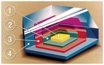
Ein Blick in das Innenleben eines Multistruktur-Silberhalogenid-Kristalls (SEM von Agfa): 1. = Kern zur Bestimmung der Kristallform, 2. = Zone zur Stabilisierung der Kristallform, 3. = Zone zur Stabilisierung der Empfindlichkeit, 4. = Trägerschicht für die farbempfindlichkeitsgebenden Sensibilisatoren und Empfindlichkeitszentren. (Agfa-Gevaert)
