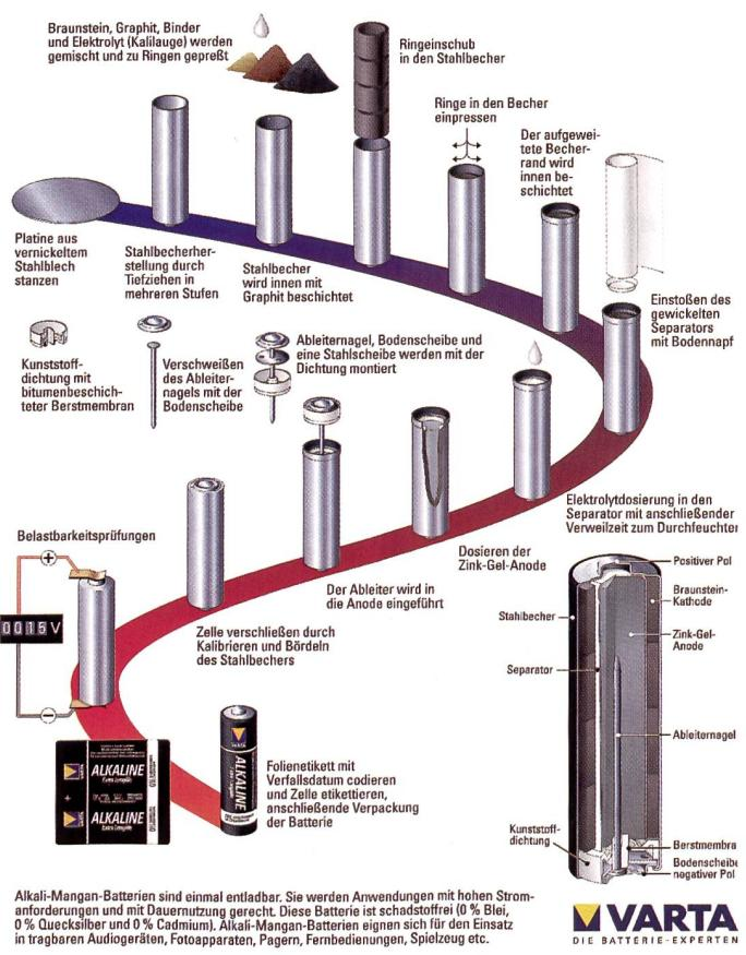
Alkali-Mangan-Batterien sind einmal entladbar. Sie werden Anwendungen mit hohen Stromanforderungen und mit Dauerhaltung gerecht. Diese Batterie ist schadstofffrei (0 % Blei, 0 % Quecksilber und 0 % Cadmium). Alkali-Mangan-Batterien eignen sich für den Einsatz in tragbaren Audiogeräten, Fotoapparaten, Pagers, Fernbedienungen, Spielzeug etc.
