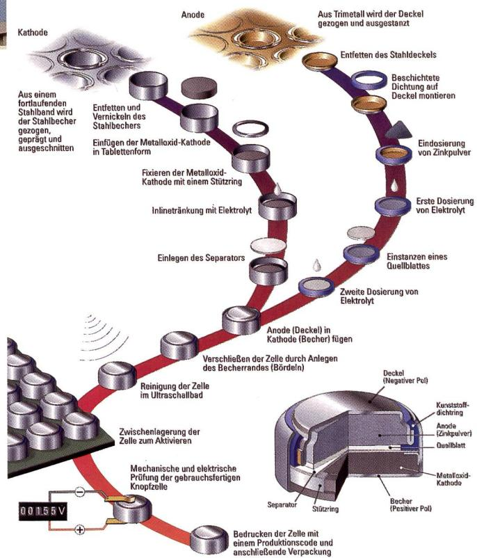
Silberoxid-Zink-Knopfzellen sind einmal entladbar. Sie zeichnen sich durch hohe, konstante Spannung und geringe Selbstentladung aus. Silberoxid-Zink-Knopfzellen eignen sich für den Einsatz in Uhren, Fotoapparaten und Taschenrechnern.
