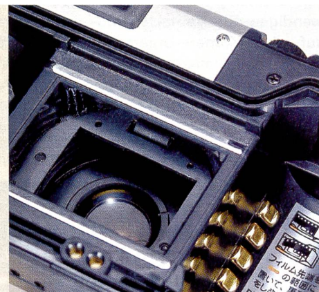
Die Filmführung ist aus Metall gefertigt, der Filmtransport erfolgt automatisch.
