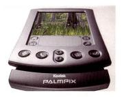
2fach-Zoom gelungen ist. Der CMOS-Sensor liefert eine Auflösung von 800 x 600 Pixel bei 24-Bit-Farbtiefe. Die Bildübertragung zum PC erfolgt über die Infrarot-Schnittstelle. Im Moment ist eine Datenübertragung mitt els eines Handys noch nicht möglich. Die Kodak PalmPix ist ab Juli erhältlich, der Endverbraucherpreis ist noch nicht bekannt.
