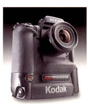
Die Belichtungszeiten sind von 1/8000 bis zu 30 Sekunden frei wählbar. Bildfolgen für maximal 24 Aufnahmen sind innerhalb von 1.5 Sekunden möglich. Zur Echtzeitkontrolle der Belichtung dient eine patentierte Histogrammfunktion. Im Gehäuse der Kamera sind ein Filter zur Minimierung von Moiré-Effekten und ein Auto White Balance Sensor zur Analyse des Aufnahmelichtes untergebracht.
