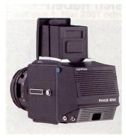
Rückteil erstmals in einem Nicht-Kodak-Produkt zum Einsatz gelangt. Der quadratische 4020 x 4020 Pixel-CCD liefert Bilder von 48 Megabyte in 24 bit RGB oder 128 MB CMYK Files im 48 Bit Format, Wird das Bild - wie heute üblich - beschnitten auf ein Seitenverhältnis von 2:3, bedeutet dies immer noch eine Datenmenge von 32 MB. Anders ausgedrückt: 78 Prozent grösser als die 18 MB Dateien der bisherigen LightPhase-Rückteile.
