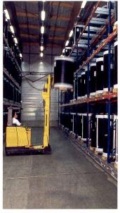
Oben: In hohen Stapeln lagern die Agfacolor-Papier-Grossrollen im Konfektionierungsbetrieb, um auf Breiten von 3,5 bis 142 cm geschnitten zu werden. Foto: Aafa-Gevaert/Schlosser Links: In mehreren Bahnen und verschiedenen Formaten verlassen die im Grosslabor belichteten Papierrollen die Entwicklungsmaschine. Foto: Gert Koshofer
