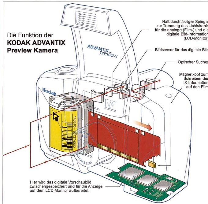
So funktioniert die Advantix Preview: Das Sucherbild gelangt über einen teildurchlässigen Spiegel und eine Optik auf einen CCD-Sensor.
