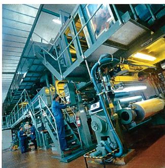
Eine der drei Begiessanlagen, auf denen jährlich 20 Millionen Quadratmeter Folien und Druckmedien produziert werden. Ein beträchtlicher Anteil davon wird exportiert und unter anderen Markennamen verkauft.
