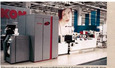
Alternative zum heutigen Nassverfahren sind Anlagen, die nach dem elektrostatischen Tonerprinzip arbeiten, wie Indigo und Xeikon (Bild).
