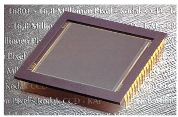
Der neue CCD-Chip von Kodak mit 16,8 Millionen Bildpunkten wird in etwa einem halben Jahr in einem Digitalrückteil für Mittelformatkameras auf den Markt kommen.
