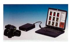
tik-Verbindung über eine PCI-Karte in den Computer übertragen. Diese auch beim raschen Generationenwechsel von Apple bewährte Technik bietet verschiedene Vorteile: beinahe unbegrenzte Übertragungsgeschwindigkeit und Unempfindlichkeit gegenüber elektronischen Störfeldern (z.B. von Netzkabeln), die bei elektrischer Signalleitung zu Beschädigung der Bilddaten verminderten Datenübertragungsraten führen können.
