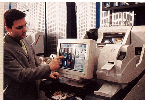
Das Gretag Master Lab Digital ist mit nur 1,3 m² Standfläche das kompakteste Minilab der Leistungsklasse von 1000 Bildern pro Stunde. Es wird komfortabel über einen Touchscreen bedient.
