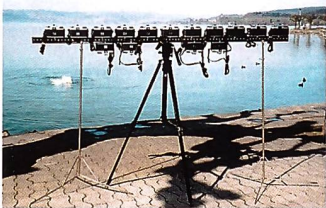
Um absolut identische Filme belichten zu können, wurden 15 Minolta-Kameras auf ein Gestell montiert.
