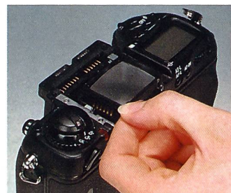
Bei F5-Fotografen besonders beliebt ist das auswechselbare Suchersystem und das einfache Wechseln der Einstellscheiben.
