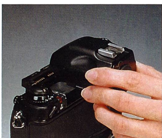
Bei F5-Fotografen besonders beliebt ist das auswechselbare Suchersystem und das einfache Wechseln der Einstellscheiben.
