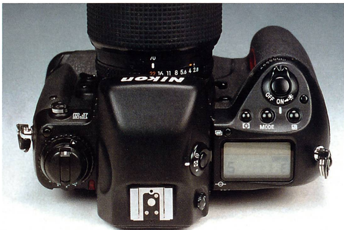
Die Oberseite der Nikon F5 präsentiert sich durch eine logische und übersichtliche Anordnung der Bedienelemente.
