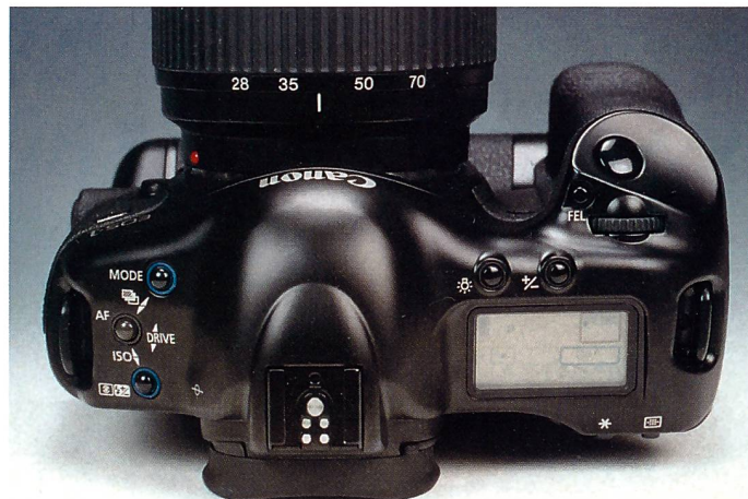
Bei der neuen Canon EOS-1V fällt die Abwesenheit der Rückspulkurbel auf. Viele der Bedientasten haben Mehrfachfunktionen.
