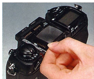
Bei F5-Fotografen besonders beliebt ist das auswechselbare Suchersystem und das einfache Wechseln der Einstellscheiben.
