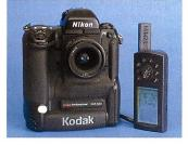
GPS-Geräte können mit der Kamera direkt verbunden werden, um GPS-Daten zu speichern.
