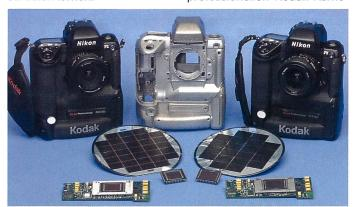
Kameratechnische Basis der neuen Kodak DCS 620x ist die profibewährte Nikon F5 mit ihrem Leichtmetallgehäuse. Im Vordergrund sind zwei Wafers, zwei CCD-Sensoren und zwei DCS-Bords zu sehen.
