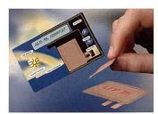
Flachzelle zum Beispiel entlang einer Gehäusewandung untergebracht werden kann und kaum zusätzlichen Platz benötigt, ermöglicht ein völlig neues Vorgehen bei der Formgestaltung elektronischer Geräte. (Foto Varta)
