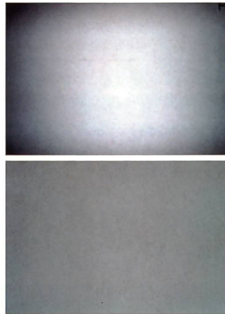
Die Blitzausleuchtung bei (vlnr) Minolta, Olympus und Pentax bei Weitwinkel (oben) und Tele (unten).
