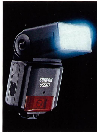
Systemblitzgeräte mit Autofokus-Messleuchte kommunizieren interaktiv mit der Kameraelektronik. (Foto: Sunpak)
