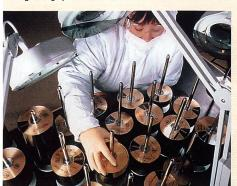
Polycarbonat-Kunststoff wird trocknet, gesäubert und kommt in die Spritzgussanlage, Dort wird das Polycar bonat auf 300 Grad Celsius erhitzt. Im Spritzgussverfahren wird so das Disc-Substrat hergestellt, auf das die Farbschichten aufgetragen werden. Die Pressform «presst» dann eine 5,6 km lange Rille auf das Substrat. Der
