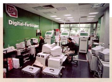
Blick hinter die Kulisse: Im Laborraum sind vier Arbeitsstationen, auf denen die entwickelten Filme eingescannt, die Daten ans Netzwerk gesandt und die CDs gebrannt werden. Im Hintergrund sind die drei Fuji Frontier 1000 zu sehen.
