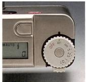
Ähnliche Bedienungselemente für manuelle Entfernungseinstellung und die Zoomverstellung. Letztere ist bei der Contax Tvs III (links) auf zwei Tasten verlegt, während die Leica minilux zoom über einen Wippschalter unterhalb des Bedienungsrades verfügt.
