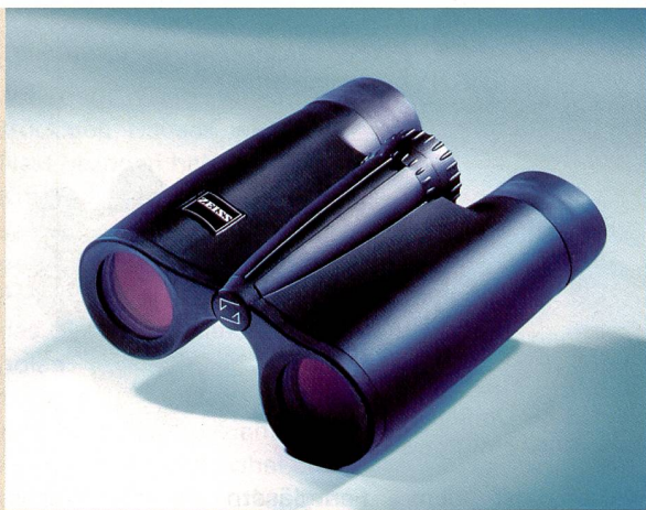
Das neue Zeiss 8x30 B MC Diafun ist eine Dachkantprisma-konstruktion mit einem leichten und robusten Gehäuse aus glasfaserverstärktem Spezialkunststoff. Es hat Spezialokulare, die auch Brillenträgern das volle Sehfeld von 100 m auf 1000 m Distanz bieten.
