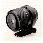
Da dieses Spezialobjektiv speziell auf die Makrofotografie ausgerichtet und entsprechend neu berechnet ist, wurde auf eine Unendlichkeitseinstellung verzichtet. Der Arbeitsbereich liegt zwischen 41 und 101 mm. Das Objektiv besteht aus zehn Linsen in acht Grup-
