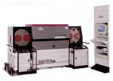
Für das Grossfinishing bietet Gretag komplette Produktionsstrassen, vom Spleisser über Printer bis zur Auftragssortieranlage.
