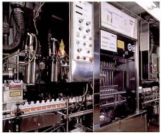
Automatische Füllstrasse für Kleinflaschen.
