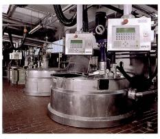
Ansatzbottiche mit integriertem Rührwerk.
