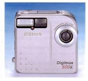
bedienen ist und für viele Anwendungen mit 800'000 Bildpunkten eine ausreichende Auflösung (1024 x 768 Pixel) bietet. Das Fixfokusobjektiv ermöglicht Aufnahmen von 22 cm mit Makroeinstellung bis unendlich. Um Batteriestrom zu sparen verzichtet die Digimax 800K auf einen LCD-Monitor und bietet einen Durchsichtssucher zur Motivwahl. Ein Adapter für die serielle Schnittstelle des Computer sowie der dazugehörende Twain-Treiber werden
