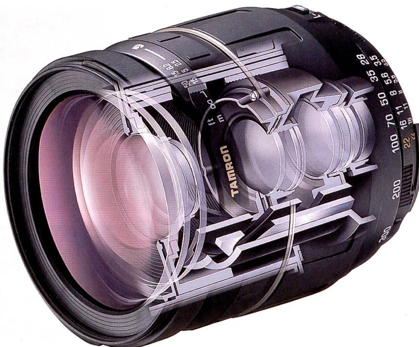
men und verfügt über Tamrons neues und exklusives Innenfokus-System. Der Zoom-Mechanismus mit vier Nocken sorgt für beste Makro-Eigenschaften und kürzesten Aufnahmeentfernungen (1,26 m bei 28mm, 61 cm bei 200mm und 82 cm bei 300mm). Der Zoom-Mechanismus mit vier Tuben stellt einen beachtlichen Fortschritt in der mechanischen Objektiv-Konstruktion dar und ermöglicht trotz der grossen Tele-Brennweite von 300 mm einen kompakten mechanischen Aufbau. Zusammen mit der Innenfokussierung konnte
