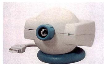
geöffnet werden und die Installation einer Karte ist nicht notwendig. Das Verbindungskabel der Kamera wird nur in die USB Buchse eingesteckt und sofort vom Betriebssystem (Windows 98) erkannt. Die Kamera kann während des Betriebs problemlos eingeschaltet und ausgesteckt werden und kostet nur Fr. 320.–.
