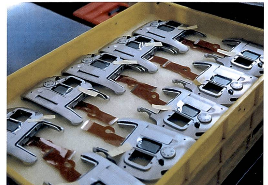
Die fertig montierten Rückwände gelangen lotweise in die Fertigungsstrasse der Pronea S.
