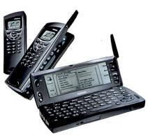
Der im Taschenformat gebaute Communicator wiegt nur noch 249 Gramm. Er bietet diverse neue Applikationen Diese ermöglichen einen problemlosen Datenaustausch zwischen Communicator und PC. Erstmals ist die mobile Bildübertragung möglich, und erstmals gibt es als Zubehör eine MultiMedia Card (MMC) als zusätzlichen Datenspeicher, Der neue Communicator hat einen hochauflösenden Bildschirm mit Hintergrundbeleuchtung, die Funktionalität der Tastatur wurde
