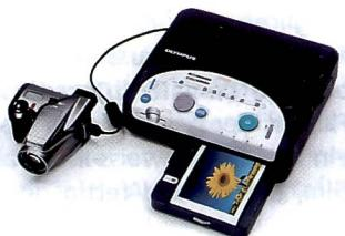
Weiter können, dank eines entsprechenden Slots, auch die auf SmartMedia-Karten gespeicherten Digitalbilder direkt ausgedruckt werden. Der neue Thermosublimationsdrucker erzielt eine Auflösung von 306 dpi. Zusätzlich zum Multiprint-Modus, der die Wahl zwischen der Teilung des Postkartenformats in vier, neun oder 16 gleich grosse Bildfelder erlaubt, lassen sich in Verbindung mit einem TV-Gerät Bildschärfe und Bildausschnitt optimieren.
