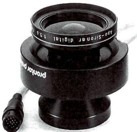
Ausreichende Verstellmöglichkeiten sind bei Bildkreisdurchmessern bis zu 180 mm je nach Brennweite gewährleistet. Das Auflösungsvermögen von mindestens 40 Linienpaaren bei 40% Kontrast über das gesamte Bildfeld erlaubt den Einsatz der Objektive für alle digitalen Kamerarückteile ohne Einschränkung.
