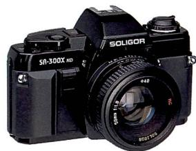
stattet: Zeitäutomatik (A) und manuelles LED-Nachführsystem (M), mittenbetonte Integral-Belichtungsmessung mit Messwertspeicher, Sucheranzeigen für alle wichtigen Kamerafunktionen, Blitzsynchrosynchronisation von 1/60 s, Mittenkontakt und automatische Synchronzeitumstellung auf 1/60 s mit Systemblitzgeräten, Filmtransport manuell oder über den optionalen Power Winder. An der neuen Soligor-Spiegelreflexkamera können alle MF-Objektive mit Minolta MD-Bajonett verwendet werden.
