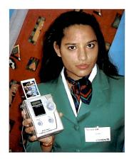
Noch als Prototyp gezeigt wurde eine neue **Hybridkamera**, die ein digitales Bild (1,7 MB-Chip) auf SmartMedia-Speicherkarte aufzeichnet und gleichzeitig ein Instax-Mini Bild ausgibt. Wann und in welchen Ländern diese
