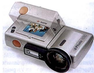
der Agfa PhotoGenie-Technologie kann die ePhoto 1680 sogar digitale Fotos mit bis zu 1,9 Millionen Pixeln liefern. Weitere Besonderheiten sind um 280° schwenkbare Sechsfach-Zoomobjektiv (dreifach optisch und zweifach digital), der 5 cm grosse LCD-Monitor und die wechselbaren SmartMedia-Speicherkerarten.
