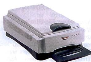
Der bewährte Agfa DuoScan für Aufsichts- und Durchsichtsvorlagen (TwinPlate-Technologie) wird gleich in zwei neuen Versionen gezeigt. Der Agfa DuoScan T1200 ist für den Büro- und Bildungsbereich gedacht, besitzt eine Auflösung von 600 x 1200 ppi (bei 3 x 12 Bit Farbtiefe) und wird mit FotoLook 3.0, Omnipage Limited und Corel PhotoPaint 8 ausgeliefert.
