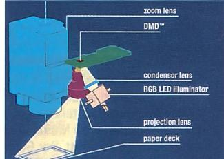
tungsmodul ist hierbei eine Hochleistungs-LED-Einheit. Der gesamte Belichtungsvorgang dauert weniger als 200 Millisekunden.
