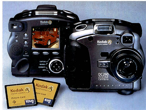
Mit der DC260, die über einen Sensor mit 1548 x 1032 Pixeln verfügt, hat sich Kodak im Rennen der Pixelboliden knapp an die Spitze gesetzt.
