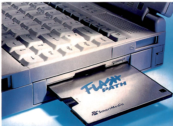
Mit Hilfe eines FlashPath-Adapters von Fuji, Olympus oder Toshiba können SmartMedia-Speicherkarten über jedes 3,5"-Disketten-Laufwerk gelesen und auf die Harddisk übertragen werden.
